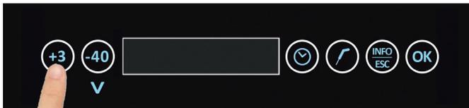
Verwenden Sie die Tasten +3 oder -40, um den korrekten Wert auszuwählen. Um zum nächsten Datum überzugehen, drücken Sie die Taste BESTÄTIGUNG.
