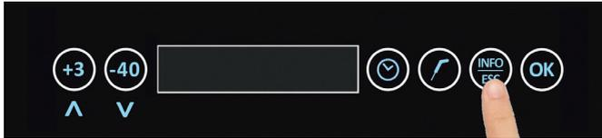
Wird am Display READY angezeigt, drücken Sie die Taste Info-ESC.
