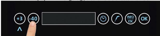
Wählen Sie anschließend mit den Tasten +3 oder -40 das Untermenü 3 aus
