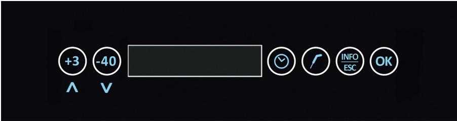
Die Modelle sind mit der Leistungsplatine „Compact“ und dem kapazitiven Display „Glass“ ausgestattet. Die Benutzeroberfläche ist mit einem 6-stelligen LED-Display, Scroll-Anzeige und den folgenden 6 kapazitiven Tasten versehen:
