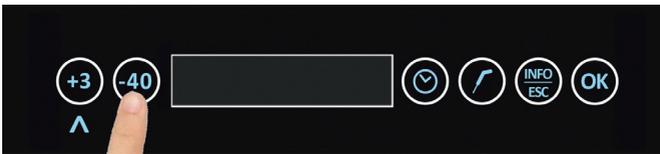
Wählen Sie anschließend mit den Tasten +3 oder -40 das Untermenü 5 aus
